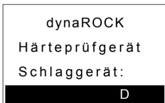
Der Typ des Schlaggerätes wird automatisch erkannt und angezeigt. An dieser Stelle sollte überprüft werden, ob der Schlaggerätetyp korrekt erkannt wurde. Nach einigen Sekunden wird der Hauptbildschirm angezeigt.
